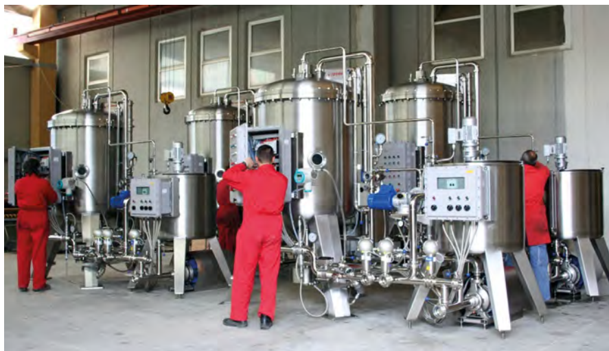
Unità di filtrazione in fase di collaudo./Filtration unit at the stage of testing.
